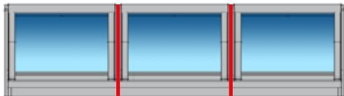
Affiancamenti realizzati con raccordi EKS con distanze di affiancamento di 10 cm a protezione degli elementi strutturali. I raccordi VELUX garantiscono una corretta giunzione tra i vari componenti, oltre a protezione e tenuta all'acqua. Le impermeabilizzazioni sottostanti sono realizzate con collare BFX.
