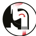
Riducendo la turbolenza all'interno della porta a lama d'aria si riduce il livello di rumore.
