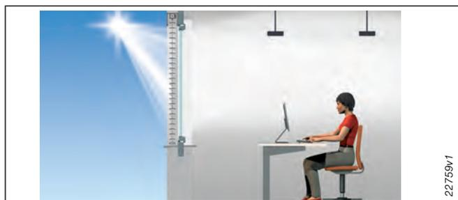
Fig. 4: Tenda frangisole con guida lamelle
