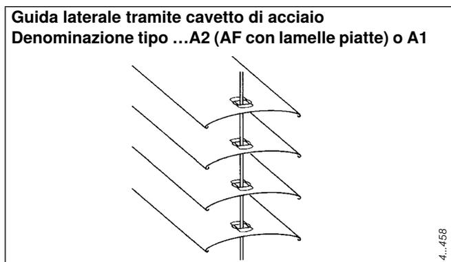
Fig. 104: Guida laterale tramite cavetto di acciaio
