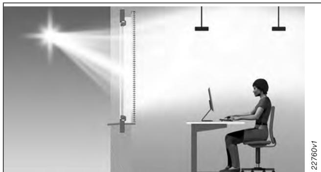
Fig. 20: Principio di orientamento della luce diurna tramite veneziane a orientamento della luce
