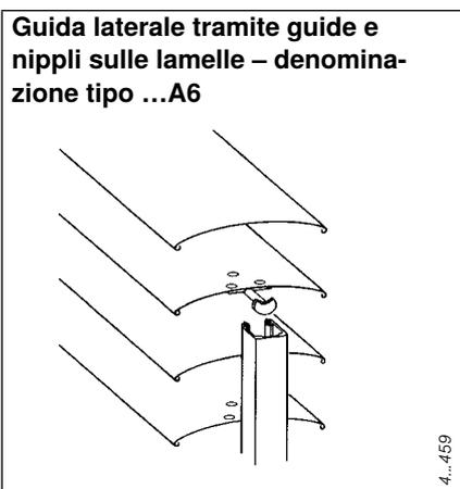
Fig. 118: Guida lamelle tramite guide
