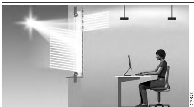
Fig. 23: Principio della veneziana a orientamento della luce con ottimizzazione per l'uso di schermi
