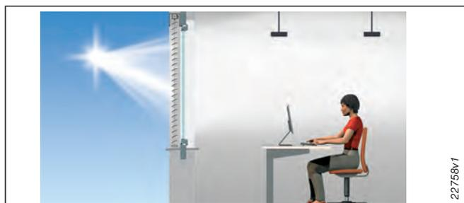
Fig. 5: Tenda frangisole con guida lamelle
