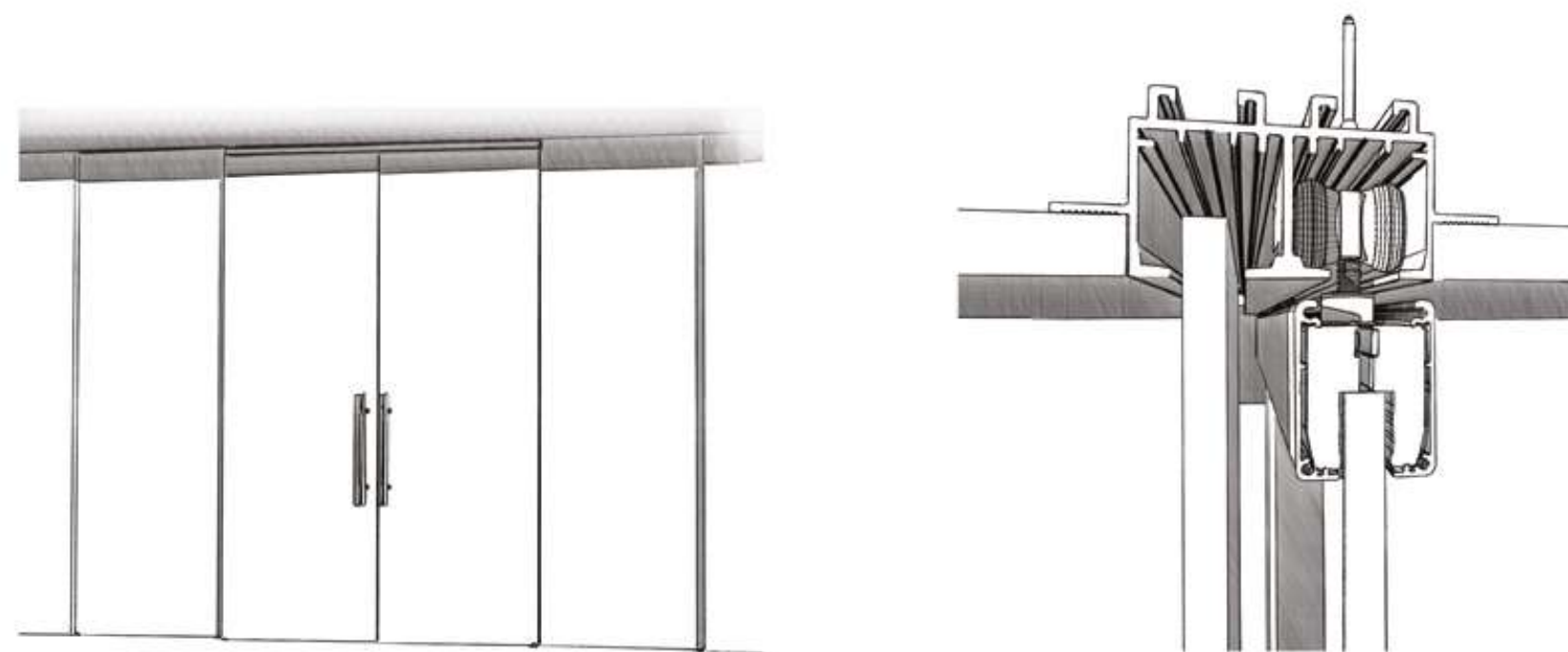
Sistema scorrevole con binario a scomparsa "TSCF 300" Due ante, una fissa e una mobile Quattro ante, due fisse e due mobili
