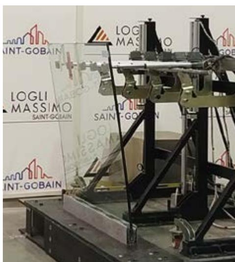
Test a carico statico ultimo. Resistenza a rottura del sistema profilo / vetro / ancoranti
