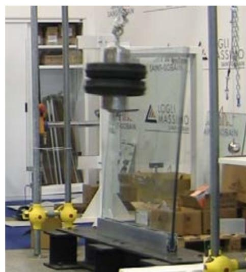
Test a carico dinamico. Impattore semi-rigido 50 kg (EN 12600), Hc= 70 cm, Hv= 110 cm
