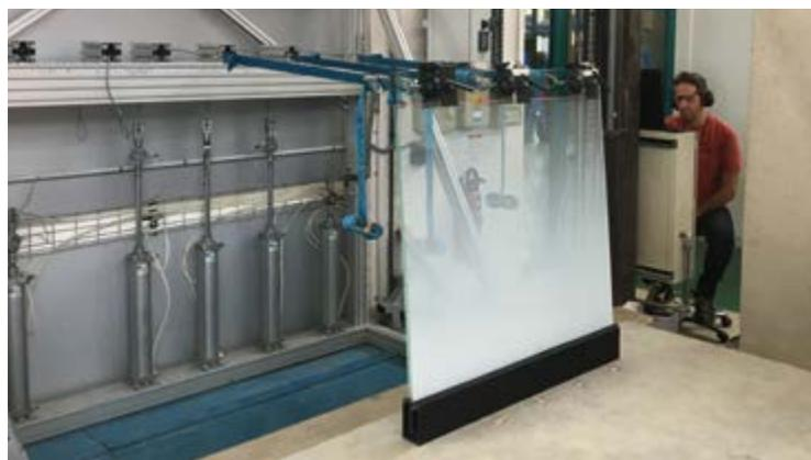
Test a carico statico 3.0 kN/m Hspinta= 110 cm
