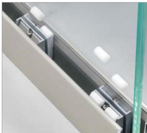
**5** Inserimento dei rulli in POM. I rulli garantiscono la migliore distribuzione del carico all'interfaccia vetro/pinza/profilo, massimizzando la performance del sistema.
