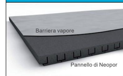
Ideale per la ristrutturazione di cassonetti per avvolgibili non isolati, con apertura sul lato locale, verso il basso o verso l'interno. Costituito da un pannello scanalato di Neopor® [ $\lambda = 0,032 \text{ W / (mK)} - \text{B1}$  (difficilmente infiammabile)] con barriera vapore all'esterno. Si può tagliare facilmente a misura con un taglierino. Il nuovo segmento a «T» assicura valori di isolamento ottimali.
