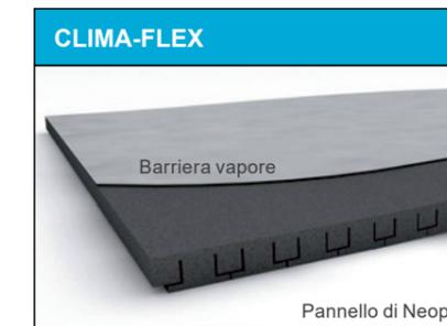
Sistema a pannello isolante CLIMA-FLEX specifico per la ristrutturazione di cassonetti per avvolgibili non isolati, con apertura sul lato locale, verso il basso o verso l'interno. Costituito da un pannello scanalato di Neopor® [ $\lambda = 0,032 \text{ W / (mK) - B1}$  (difficilmente infiammabile)] con barriera vapore all'esterno. Il sistema isolante si può tagliare facilmente a misura con un taglierino. Il nuovo segmento a «T» assicura valori di isolamento ottimali.
