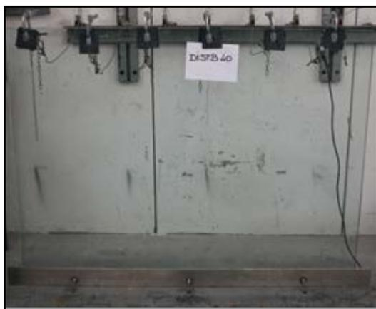
**CONCLUSIONI:** In base alla prova eseguita, ai risultati ottenuti e a quanto indicato nella tabella 3.1.11 del D.M. Infrastrutture del 14/01/2008, il campione in esame, costituito da parapetto, limitatamente al carico statico lineare orizzontale, risulta conforme alle prescrizioni del D.M. Infrastrutture del 14/01/2008 stesso.
