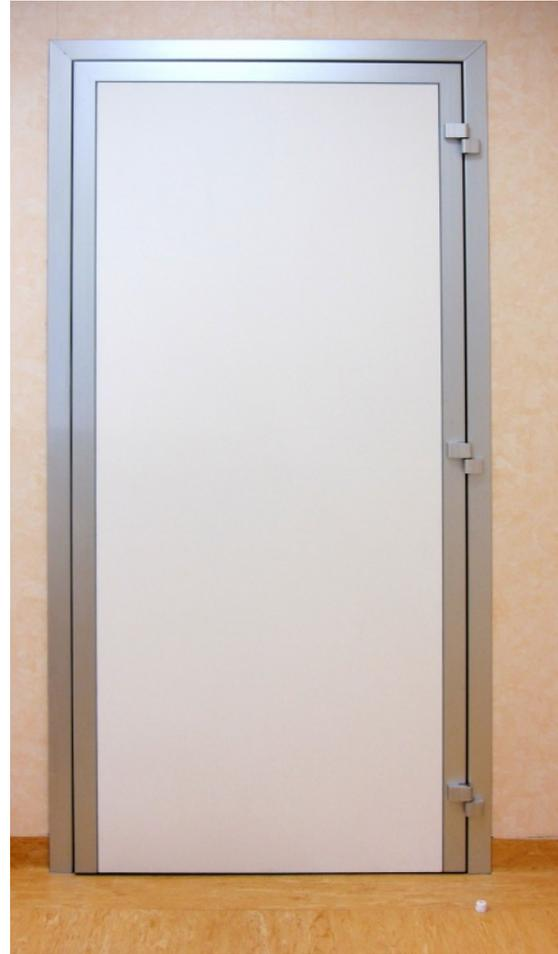
*Porta a battente automatica per ambienti a contaminazione controllata. Pannello complanare al telaio anta. Guarnizione su tre lati + guarnizione a ghigliottina sul lato inferiore.*
