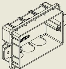
Lo spessore delle scatole elettriche è di mm 40 (2 scatole sono in dotazione per anta).
