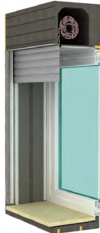
SOLUZIONE PER AVVOLGIBILE ISPEZIONE ESTERNA - TUNNEL
