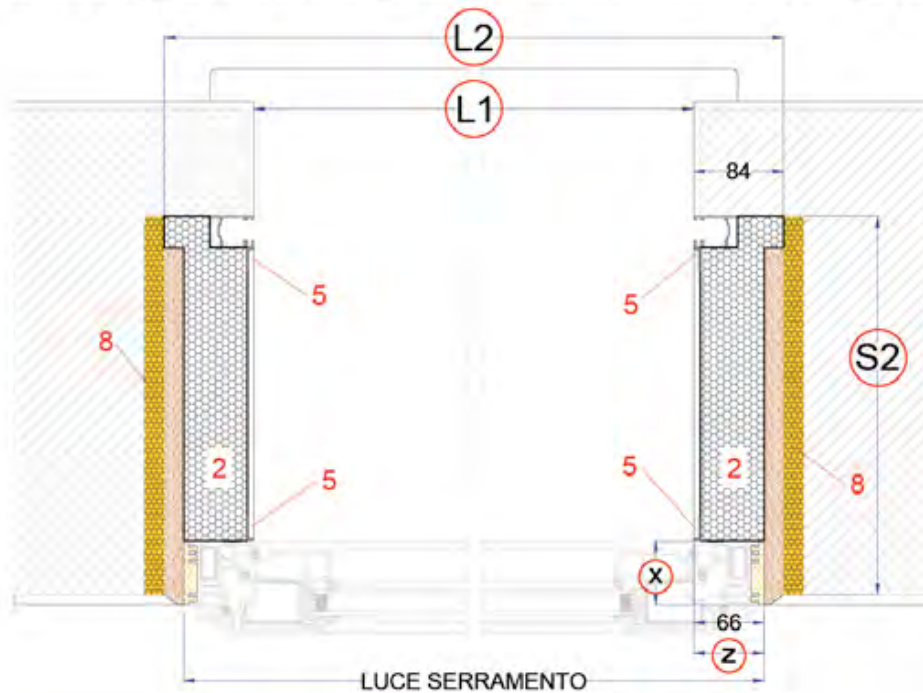
TAVOLA NR. 51 - MONOBLOCCO TERMO EASY MEZZA SPALLA - RISTRUTTURAZIONE - PER AVVOLGIBILE CON ISPEZIONE INTERNA - SERRAMENTO FILO MURO INTERNO
