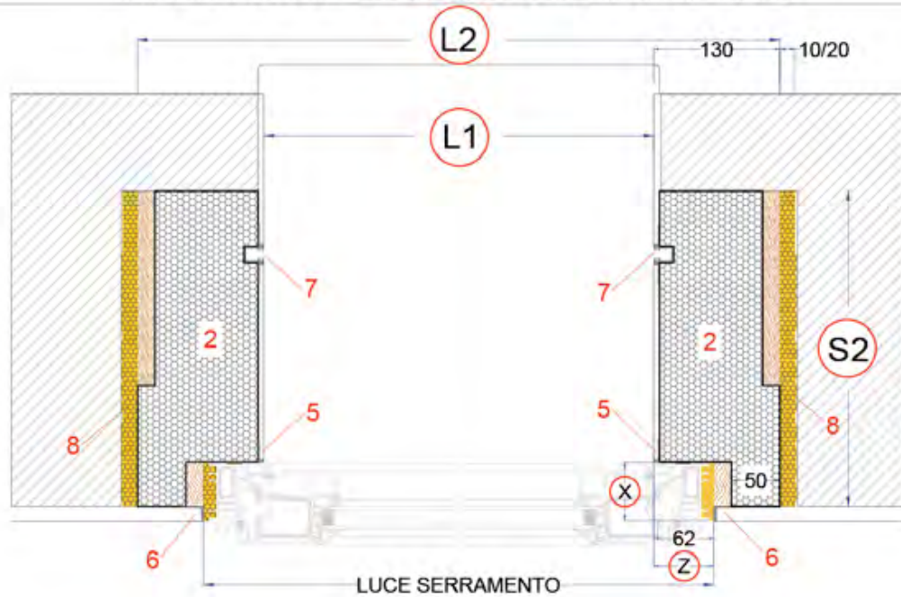
TAVOLA NR. 103 - MONOBLOCCO TERMO EASY RISTRUTTURAZIONE PER FRANGISOLE - SERRAMENTO FILO MURO INTERNO
