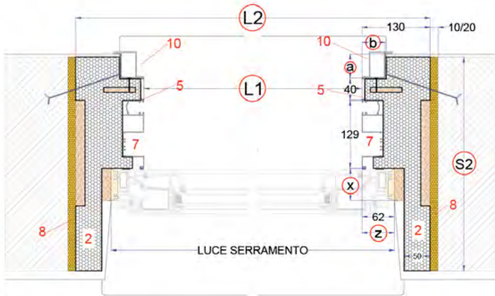
TAVOLA NR. 55 - MONOBLOCCO TERMO EASY PER AVVOLGIBILE CON ISPEZIONE ESTERNA SERRAMENTO MEZZADRIA - PREDISPOSIZIONE ZANZARIERA ED INFERRIATA ESTERNA
