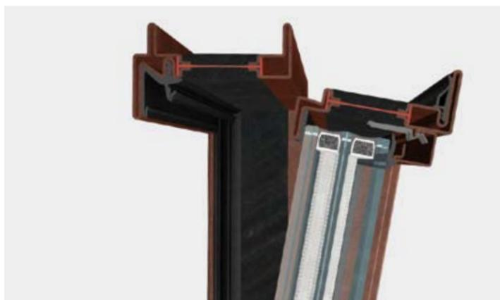
OS2 porta apertura esterna è un sistema integrato di accessori, guarnizioni e profilati a taglio termico con profondità di 77 mm che permette di realizzare un'ampia gamma di porte, rettangolari, sagomate o curve. Si possono installare vetri camera fino a 50 mm di spessore. Le caratteristiche di tenuta dei serramenti sono garantite da un sistema a doppia guarnizione di battuta.
