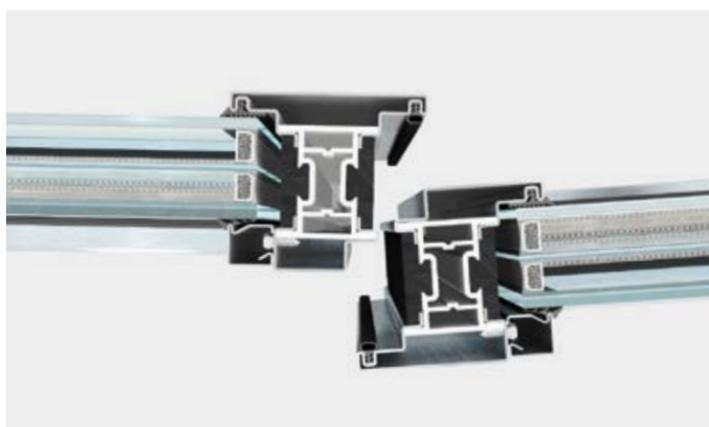
Le caratteristiche di tenuta dei serramenti sono garantite da un sistema a doppia guarnizione di battuta su tre lati e da una guarnizione a ghigliottina automatica sottozoccolo. Ogni tipologia è provvista di apposita accessoristica (anche a scomparsa) integrata. Le prestazioni del sistema a taglio termico EBE 85 sono state testate dai migliori laboratori di certificazione europei secondo le norme di riferimento EN 14351-1.
