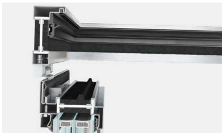
EBE 85 finestra è un sistema integrato di accessori, guarnizioni e profilati a taglio termico con profondità di 85 o 93,5 mm che consente di realizzare un'ampia gamma di finestre, rettangolari, sagomate o curve e di installare vetri a doppia camera fino a 66 mm di spessore. Ogni tipologia è provvista di apposita accessoristica (anche a scomparsa) integrata al sistema.
