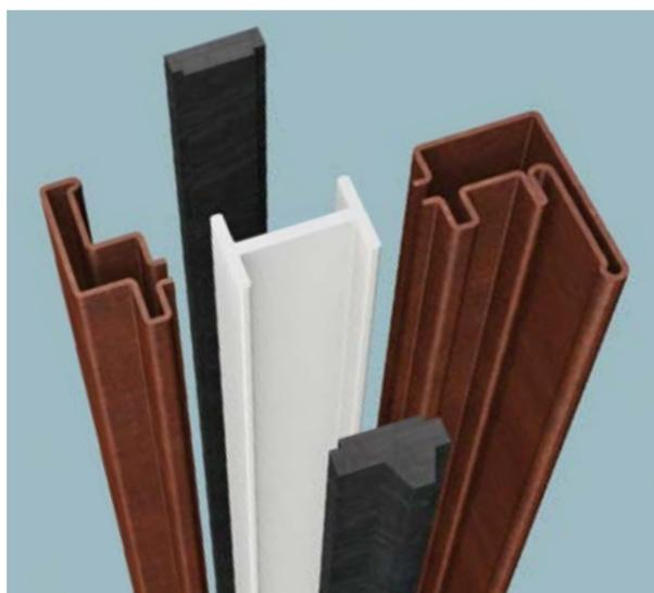
Nella famiglia EBE tutti i sistemi sono flessibili e completi, con profili snelli e forti a taglio termico. I profili del sistema **EBE 65** a taglio termico hanno profondità 65 mm e possono alloggiare vetri isolanti fino a 46 mm. Anta e telaio sono a sormonto all'interno e complanari all'esterno.
