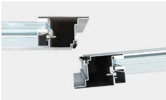
La capacità del serramento di non far passare le fiamme e i fumi caldi (tenuta al fuoco E) è garantita dalla strutturabilità del profilo e dal sistema a doppia guarnizione di battuta; la capacità di contenere l'irraggiamento dal lato non esposto alle fiamme (irraggiamento W) è ottenuta grazie agli speciali vetri installati. Le prestazioni del sistema SA AF sono state testate dai migliori laboratori di certificazione europei secondo le norme di riferimento EN 1634-1.
