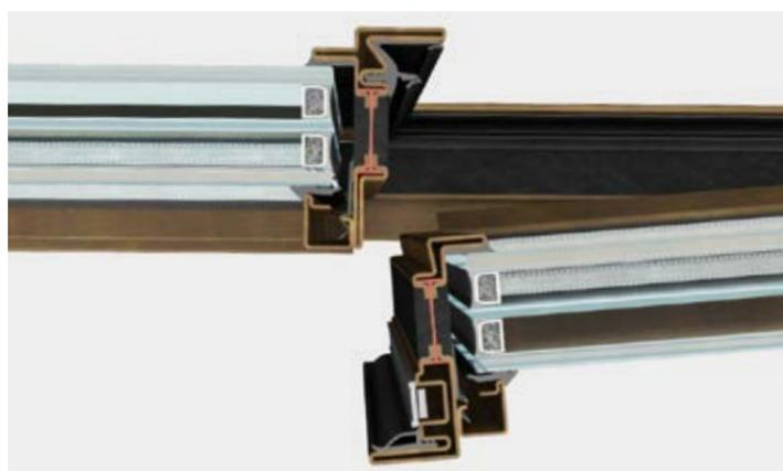
Le caratteristiche di tenuta dei serramenti sono garantite da un sistema a giunto aperto con una guarnizione centrale di tenuta e una interna di battuta. Le prestazioni del sistema a taglio termico OS2 sono state testate dai migliori laboratori di certificazione europei secondo le norme di riferimento EN 14351-1.
