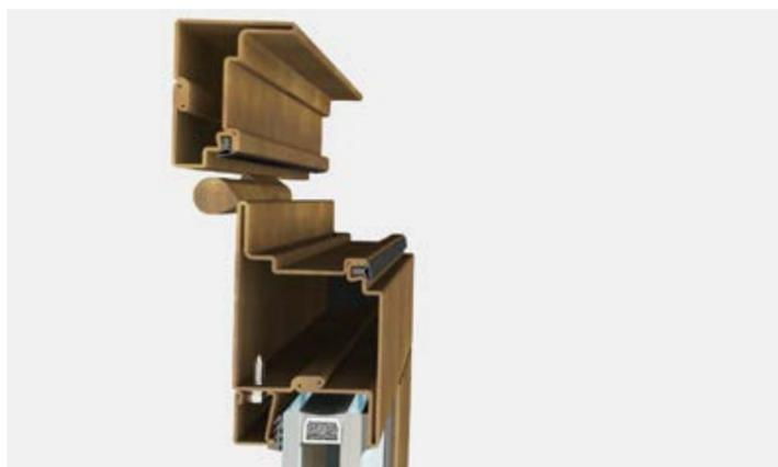
SA 15 porta è un sistema integrato di accessori, guarnizioni e profilati non isolati termicamente aventi profondità di 55 mm che consente di realizzare un'ampia gamma di porte, rettangolari, sagomate o curve. Si possono installare vetri a doppia camera fino a 35 mm di spessore. Le caratteristiche di tenuta dei serramenti sono garantite da un sistema a doppia guarnizione di battuta su tre lati e da una guarnizione a ghigliottina automatica sottozoccolo.
