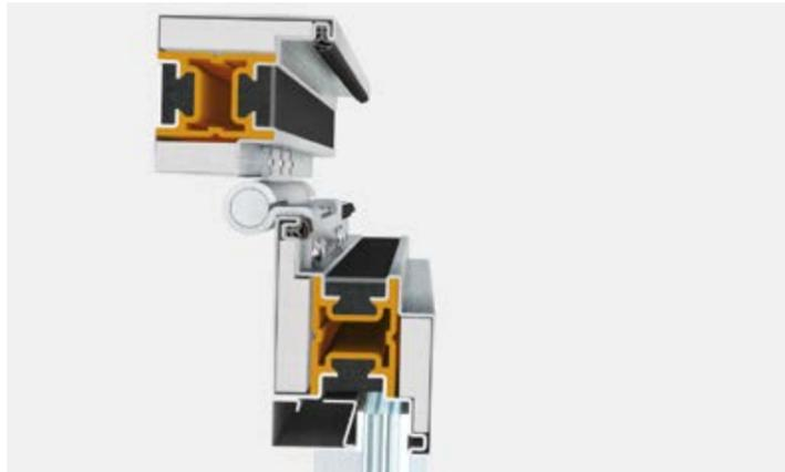
EBE AF è un sistema integrato di accessori, guarnizioni e profilati a taglio termico con profondità di 65 mm che permette di realizzare un'ampia gamma di porte e di partizioni vetrate resistenti al fuoco. Si possono installare vetri singoli o vetri camera con spessore fino a 40 mm. Ogni tipologia è provvista di apposita accessoristica certificata integrata al sistema.
