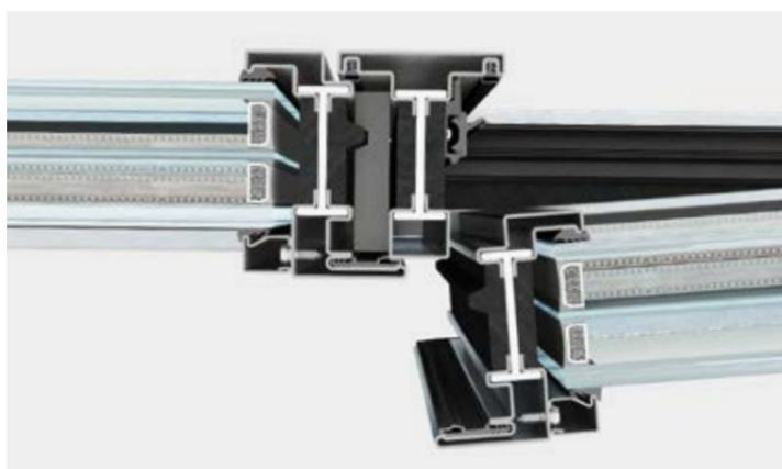
Le caratteristiche di tenuta dei serramenti sono garantite da un sistema a giunto aperto con tre livelli di tenuta. Le prestazioni del sistema a taglio termico EBE 85 sono state testate dai migliori laboratori di certificazione europei secondo le norme di riferimento EN 14351-1
