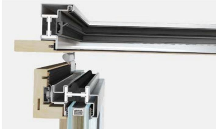
EBE ML è un sistema integrato di accessori, guarnizioni e profilati a taglio termico con profondità di 91 mm che consente di realizzare un'ampia gamma di finestre, rettangolari, sagomate o curve e di installare vetri isolanti fino 34 mm di spessore. Le caratteristiche di tenuta dei serramenti sono garantite da un sistema a giunto aperto con tre livelli di tenuta. È possibile sostituire il rivestimento interno in legno senza rimuovere il serramento.
