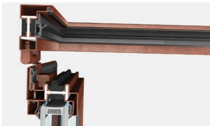
EBE 65 finestra è un sistema integrato di accessori, guarnizioni e profilati a taglio termico aventi profondità di 65 o 73,5 mm che consente di realizzare un'ampia gamma di finestre, rettangolari, sagomate o curve e di installare vetri isolanti fino a 46 mm di spessore. Ogni tipologia è provvista di apposita accessoristica (anche a scomparsa) integrata al sistema.
