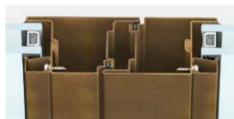
nodo centrale | sezione in vista 151 mm
