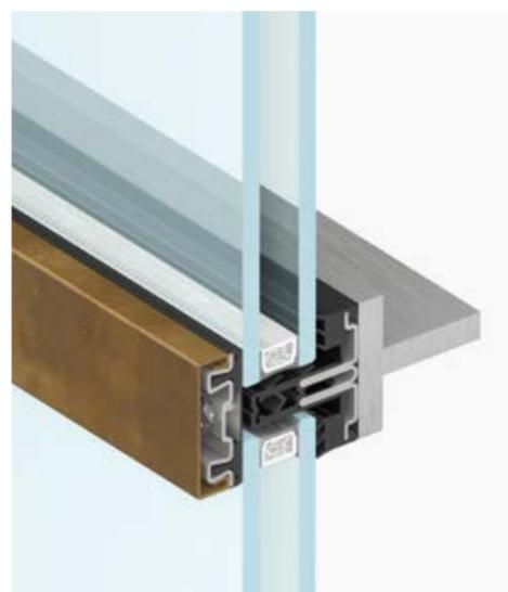
applicazione su traverso | sezione in vista 50 mm
