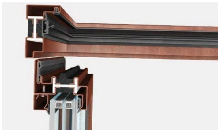
EBE 75 finestra è un sistema integrato di accessori, guarnizioni e profilati a taglio termico con profondità di 75 mm, che permette di realizzare finestre in un'ampia gamma di varianti possibili: squadrate, rettangolari, curve o sagomate e di installare vetri isolanti fino a 48 mm di spessore. Ogni tipologia è provvista di appositi accessori (anche a scomparsa) integrati al sistema.
