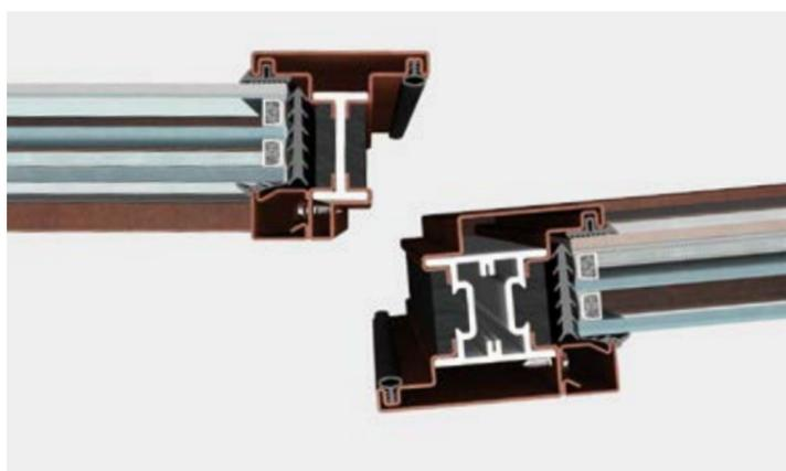
Le caratteristiche di tenuta dei serramenti sono garantite da un sistema a doppia guarnizione di battuta su tre lati e da una guarnizione a ghigliottina automatica sottozoccolo. Ogni tipologia è provvista di apposita accessoristica (anche a scomparsa) integrata. Le prestazioni del sistema a taglio termico EBE 75 sono state testate dai migliori laboratori di certificazione europei secondo le norme di riferimento EN 14351-1.
