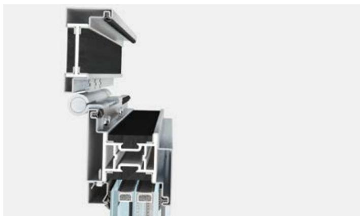
EBE 85 porta è un sistema integrato di accessori, guarnizioni e profilati a taglio termico con profondità 85 mm che consente di realizzare un'ampia gamma di porte, rettangolari, sagomate o curve. Si possono installare vetri a doppia camera fino a 60 mm di spessore.
