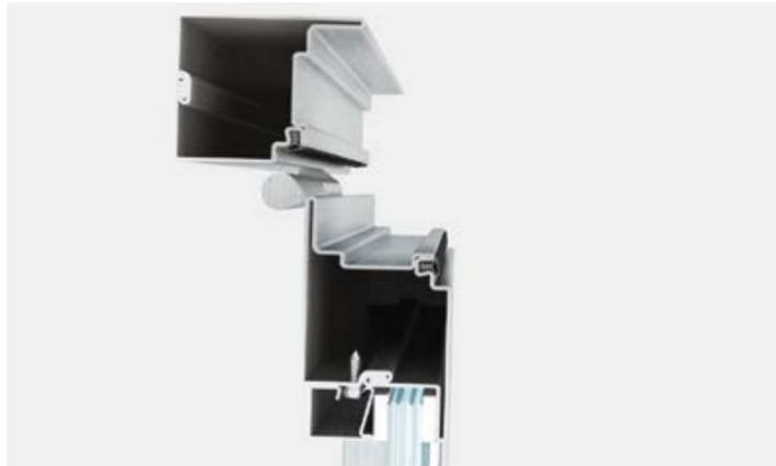
SA AF è un sistema integrato di accessori, guarnizioni e profilati non isolati termicamente con profondità di 55 mm e consente di produrre un'ampia gamma di porte e di partizioni vetrate resistenti al fuoco. Si possono installare vetri singoli o vetri camera con spessore fino a 35 mm. Ogni tipologia è provvista di apposita accessoristica certificata integrata al sistema.
