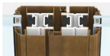
nodo centrale | sezione in vista 152 mm
