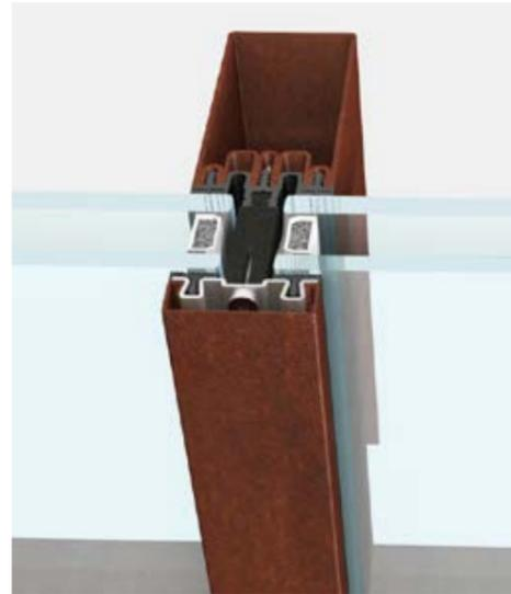
applicazione su montante | sezione in vista 50 mm
