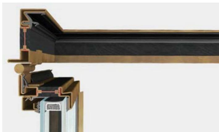
OS2 finestra apertura interna è un sistema integrato di accessori, guarnizioni e profilati a taglio termico con profondità di 65 mm che permette di realizzare un'ampia gamma di finestre, rettangolari, sagomate o curve. Si possono installare vetri camera fino a 40 mm di spessore. Ogni tipologia è provvista di apposita accessoristica integrata al sistema.
