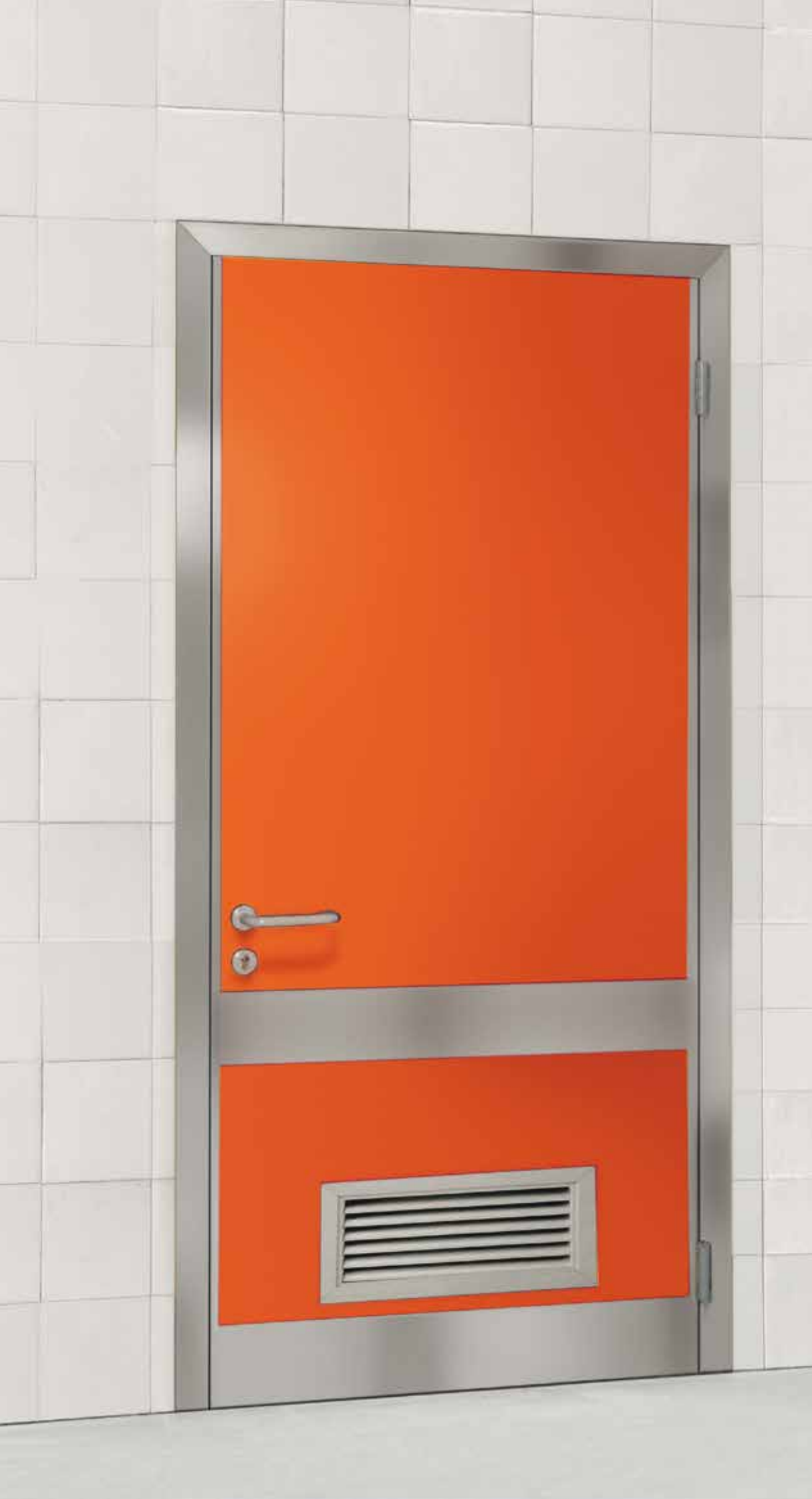
steel collection Art. 11S porta a battente - hinged door laminato - laminate finishing SP. TH. 9/10 griglia di aerazione - ventilation grill PX 001 protezione di battuta - edge protector PS 801 battibarella - stretcher plate PX 060 battipiedi - kick plate PX 030 cassa in acciaio inox - stainless steel doorframe SP. TH. 15/10 Mod. Rapid PS11F
