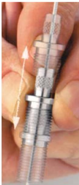
Dopo un leggero svitamento del supporto di sicurezza e una pressione sul manicotto i sistemi dinamici potranno scorrere liberamente sul cavo. Avvitare sempre il dispositivo di sicurezza dopo questa operazione
