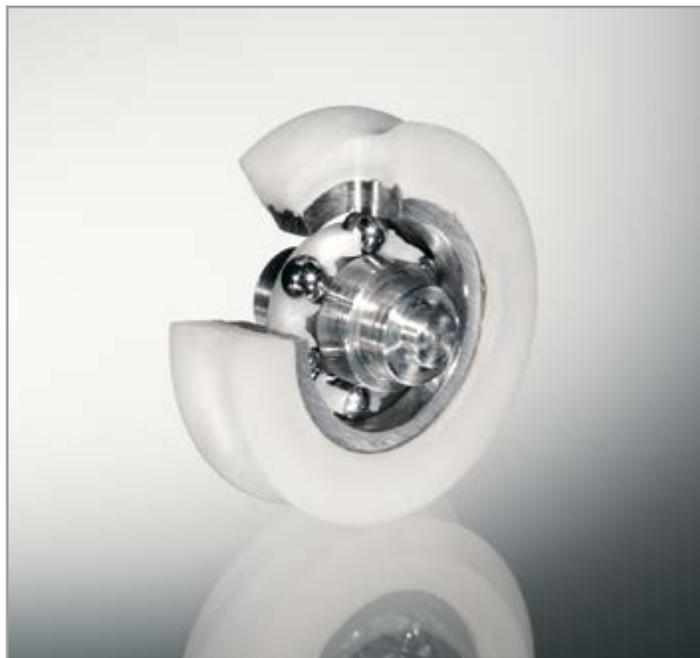
Il cuscinetto a sfere in acciaio rivestito con materiale plastico (POM) risulta essere molto resistente tale da evitare eventuali deformazioni date dall'usura e dal peso, garantendo una soddisfacente durata nel tempo, un'ampia solidità ed una riduzione naturale della rumorosità.
