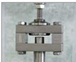
PROVA DI RESISTENZA A TRAZIONE - Fn
